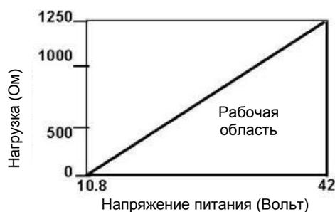
где:  $R_{\text{макс}} = 41,7(V_{\text{пит}} - 10,8)$ ;
